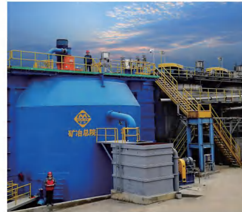
680m³ 超大型浮选机 680m³ mega flotation cell
