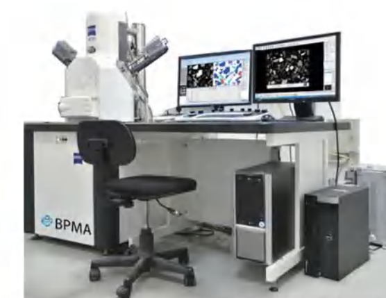
工艺矿物学自动测试系统 BGRIMM process mineralogy analyzer
