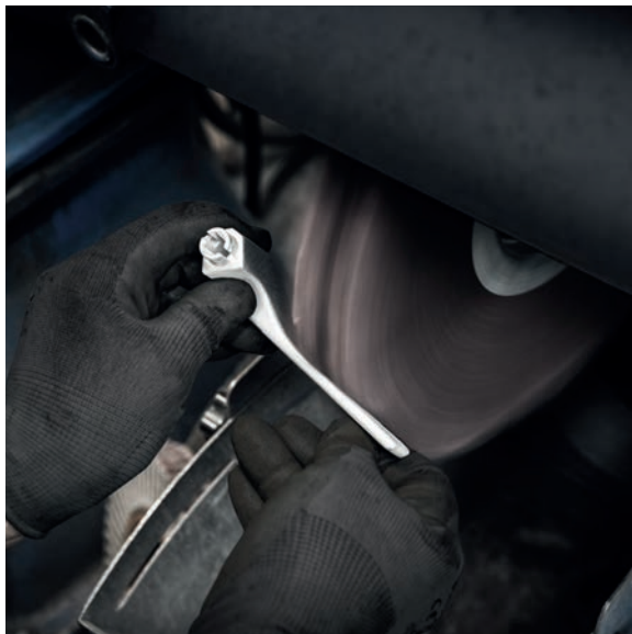
Operazione manuale di sbavatura della maniglia Alicia
