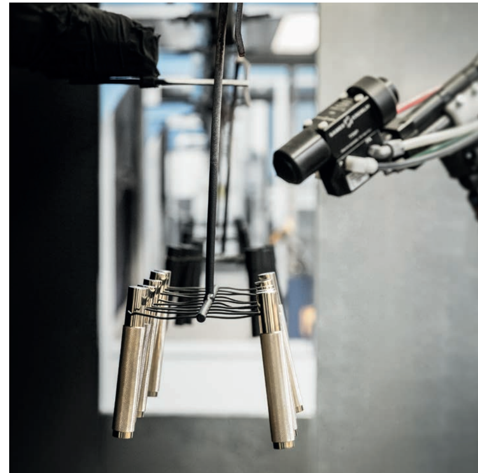
Verniciatura con robot della maniglia Marion
